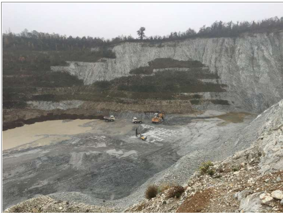
Figura 16 – Vista della zona di lavoro con perforazione, scavo e carico, con alle spalle un'area già recuperata (immagine del 06.11.2020).
