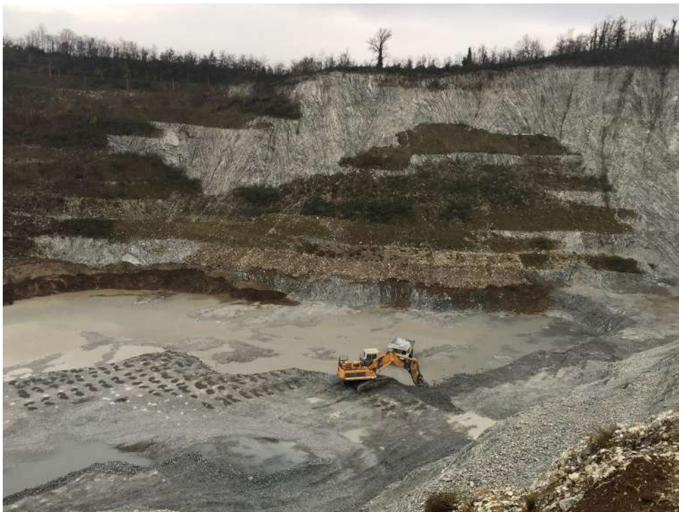
Figura 16 – Vista della zona di lavoro con perforazione, scavo e carico, con alle spalle un'area già recuperata (immagine del 09.12.2020).
