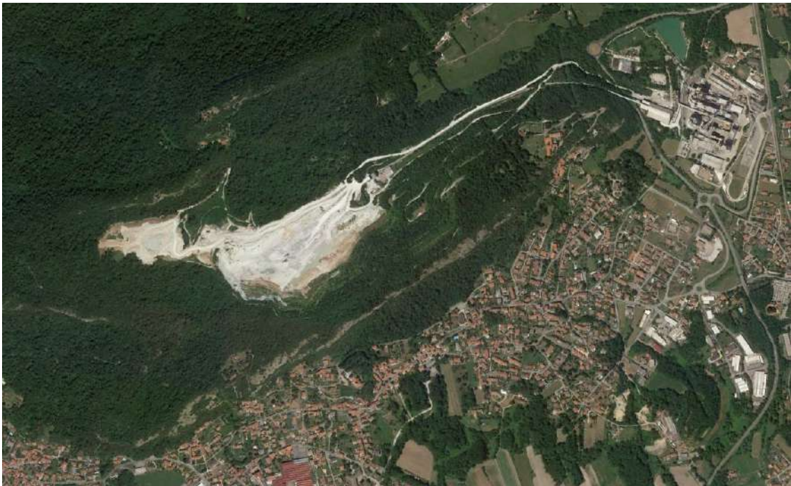
Figura 1 – Nell'immagine del giorno 9 luglio 2020, estratta dal software Google Earth PRO, si può osservare la Miniera di Sasso Poiano a ovest, la cementeria a est e il paese di Caravate a sud. Tra il paese di Caravate e la miniera di Sasso Poiano si vede una linea di colore grigio in direzione NW – SE che è la parete litoide che sovrasta l'abitato e che a volte ha determinato crolli di frammenti rocciosi.
