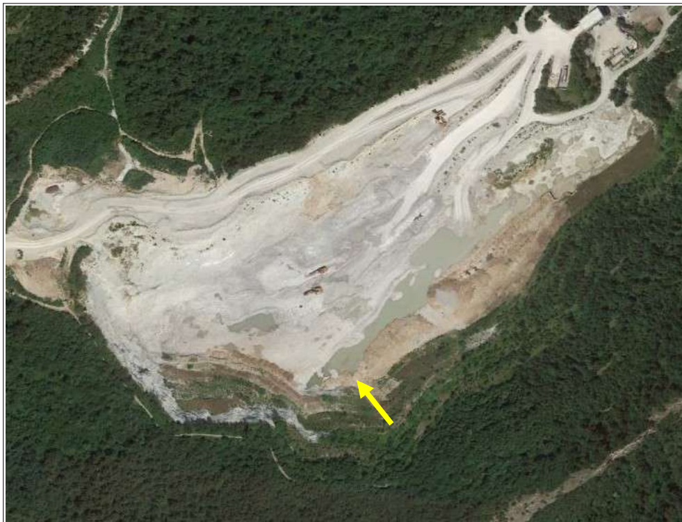
Figura 17 - Immagine del 9 luglio 2020 estratta da Google Earth PRO e nella quale è stato evidenziato con una freccia di colore giallo il solco d'erosione da sistemare preferibilmente con tecniche d'ingegneria naturalistica e con materiali vivi.
